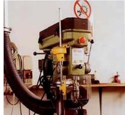
3. Protector móvil. Elemento que cubre mecánicamente a la estructura de una máquina o a un elemento vecino fijo; dicho enlace se realiza generalmente mediante una articulación o sobre guías de deslizamiento.
