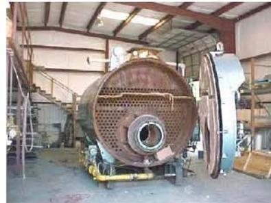
Es importante que tengas presente la diferencia entre una caldera y un generador de vapor radica en que el segundo genera vapor saturado o sobrecalentado, es decir entrega un vapor con menos humedad.
