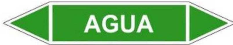
1. Debe pintarse sobre la banda de color de seguridad o bien, ubicarse en una etiqueta, placa o letrero fijado, adyacente a las bandas, y
