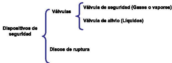
**Válvula de seguridad:** Es un elemento diseñado para liberar un exceso de presión, caracterizándose por una apertura rápida. Se utilizan principalmente en el manejo de vapor de agua, gases o vapores
